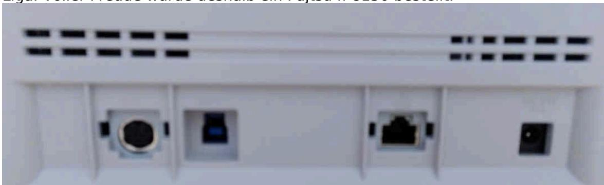
Das Gerät verfügt über USB und Netzwerkanschluss. Über USB kann das Gerät an eine jede ArchivistaBox angehängt werden. Leider entpuppte sich der Netzwerkanschluss — um es noch wohlwollend auszudrücken — als Niete. Zwar können die IP-Kenndaten über das Web-Interface festgelegt werden (Password ist password). Leider ist es nicht möglich, in diesem Interface Scans festzulegen, um z.B. auf einen Netzwerkpfad zu scannen.
