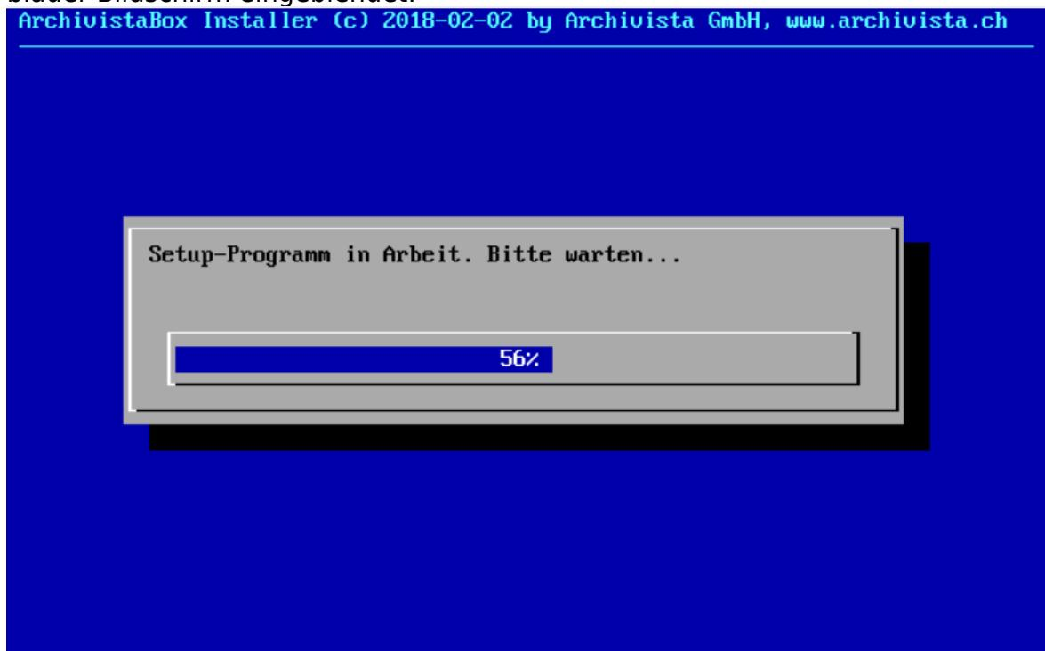
Sofern AVMultimedia eine leere Festplatte findet, wird diese formatiert. Falls bereits eine bestehende Platte vorhanden ist, wird die letzte Partition automatisch eingebunden. Das Einrichten von AVMultimedia dauert ab USB-Stick ca. eine Minute (es werden dabei ca. 3 GByte Software eingerichtet). Danach erfolgt der nachfolgende Bildschirm:
