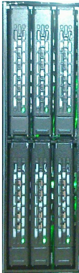
Weil über eine übliche 1-GBit-Netzwerkarte nur ca. 100 MByte pro Sekunde übertragen werden können, blieben leistungsfähige DRBD-Cluster bei ArchivistaVM den Rack-Rechnern vorbehalten. Mit SATA3 und SSD-Platten ist dies bei den neuen Modellen nicht mehr der Fall, mit 6 Platten und 3-facher Redundanz kann ein Durchsatz von bis zu 800 MByte pro Sekunde erreicht werden. Dank 10 GBit-Netzwerkarten können die Daten in Echtzeit auf eine andere ArchivistaVM-Box übertragen werden.
